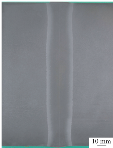
図3 レールのフラッシュバット溶接部のマクロ写真
